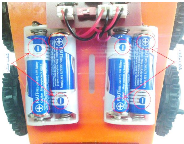
نحوه نصب صحیح باطری ها (منبع تغذیه) در جاباطری
